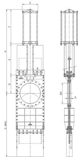
Hinweis: Dargestellte Abmessungen DN 300-800 für 10 bar Auslegungsdruck und PN10 Flanschbohrung, Abmessungen DN900-1000 für 6 bar Auslegungsdruck und PN10 Flanschbohrung
